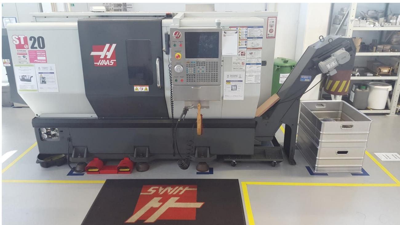
Figura 6 – Torno CNC HAAS ST-20
