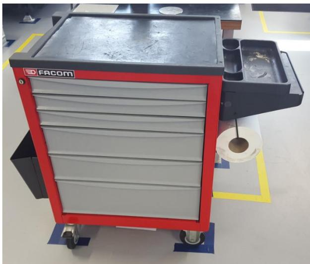
Figura 9 – Carro de ferramentas de auxílio ao torno CNC.
