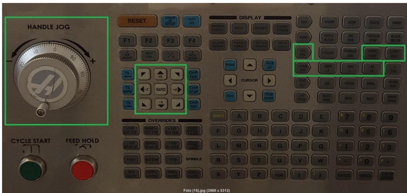
Figura 22 – Teclado e Handle Jog do torno CNC HAAS ST-20
