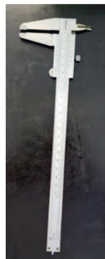
Figura 11 - Paquímetro
