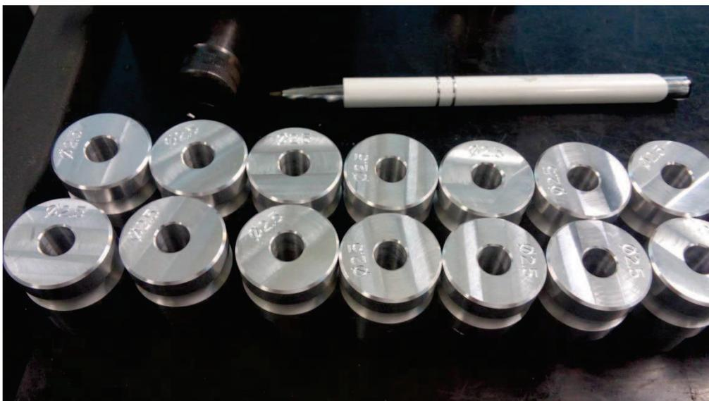
Figura 19 – Peças Finais: Quadripés com diâmetro 2,5.
