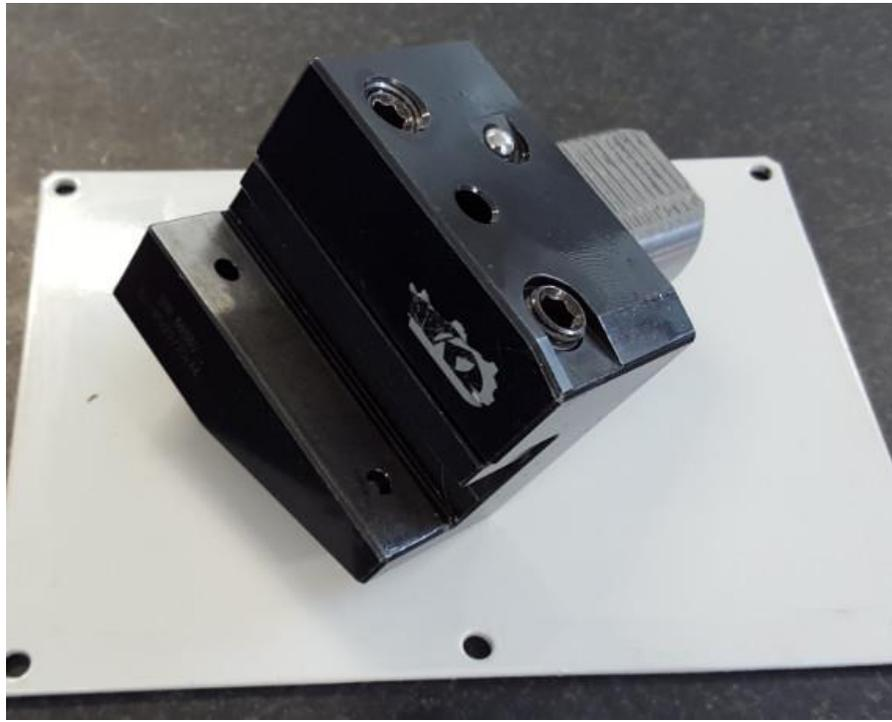
Figura 20 – Suporte para ferros exteriores
