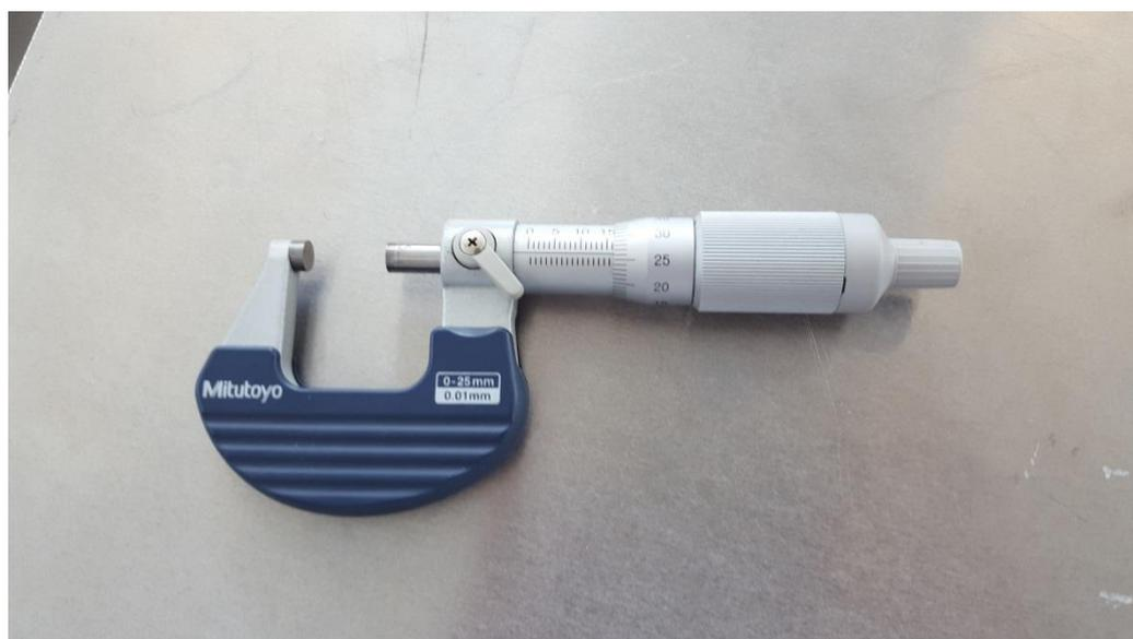
Figura - 13 – Micrómetro (0-25mm)
