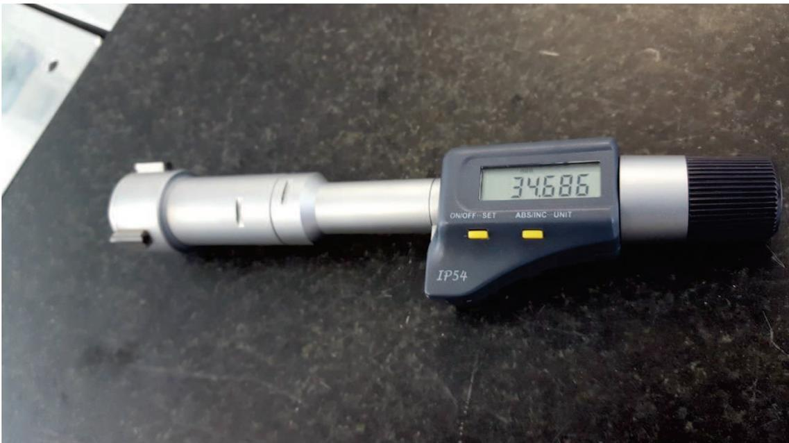
Figura 13 – Micrómetro de interiores
