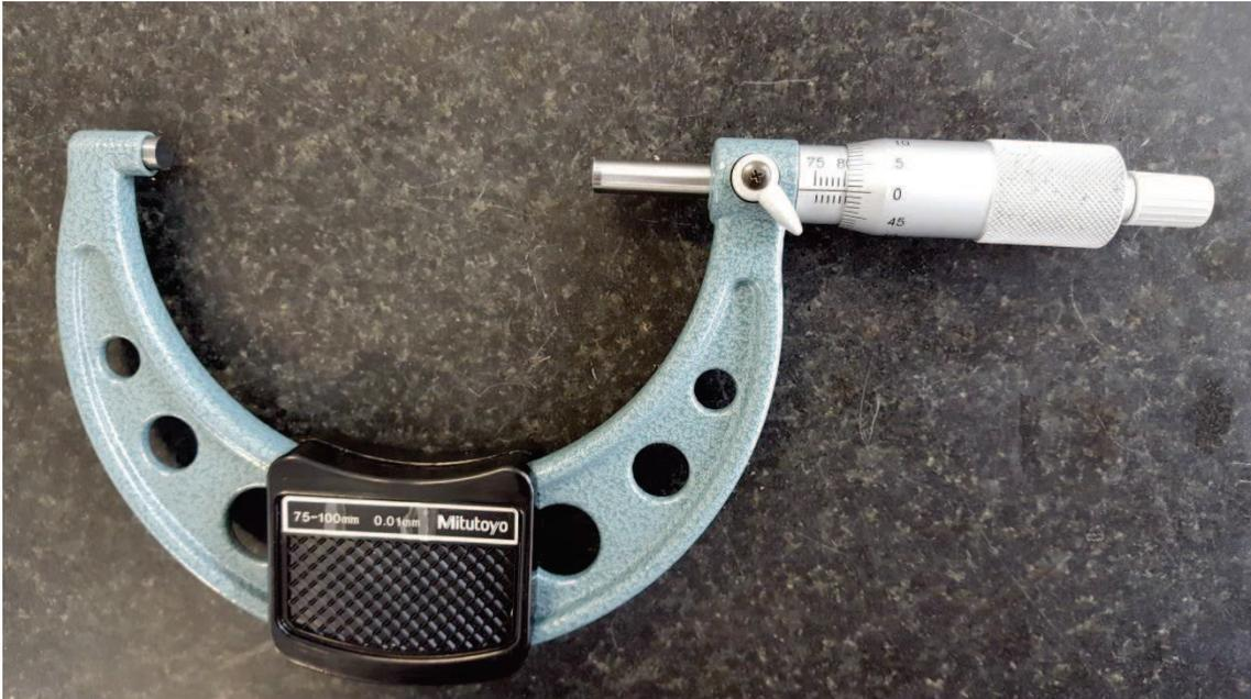
Figura 12 – Micrómetro de exteriores 75-100mm.
