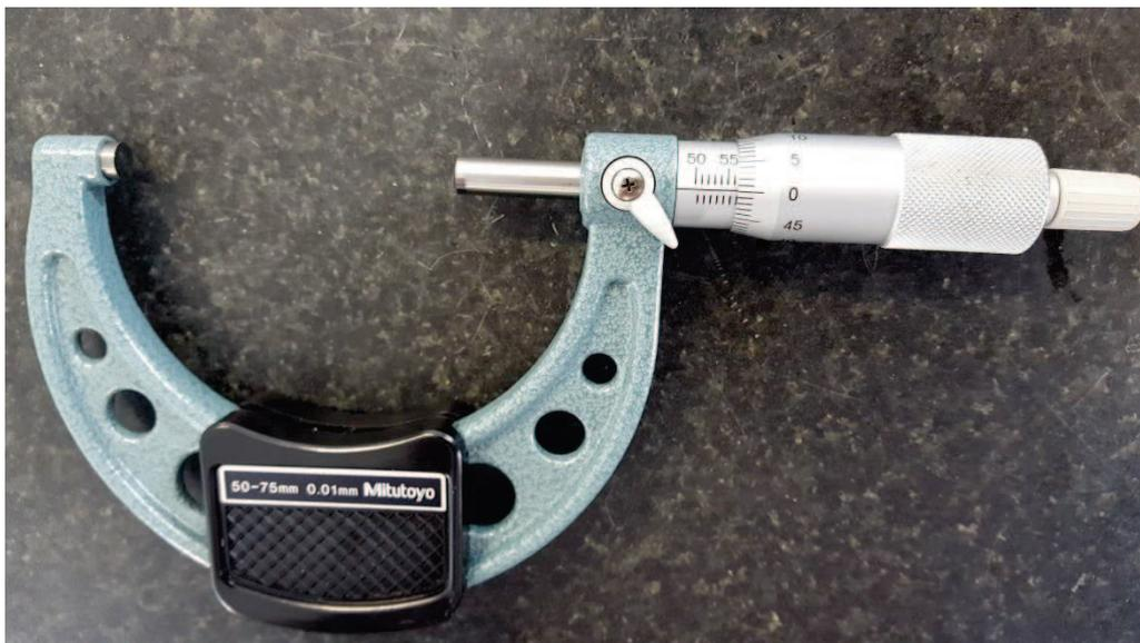
Figura 11 – Micrómetro de exteriores 50-75mm.
