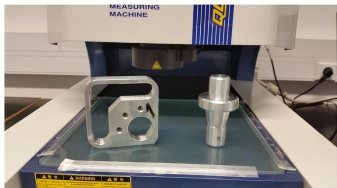
Imagem 11 e 12 – Sistema CNC de medição sem contacto
