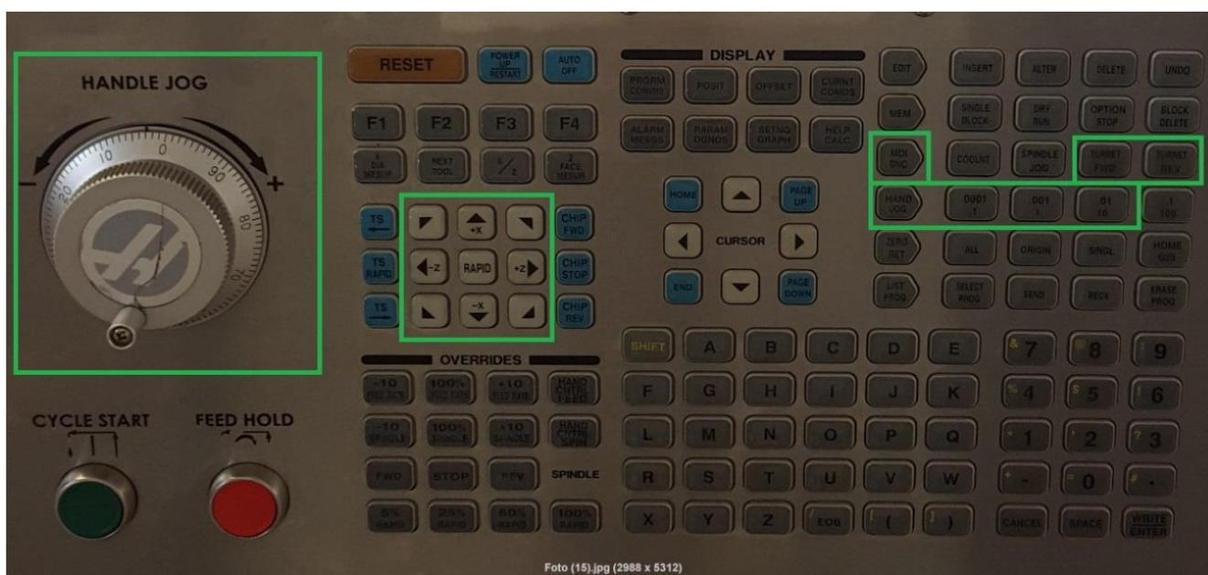
Figura 23 – Teclado e Handle Jog do torno CNC HAAS ST-20
