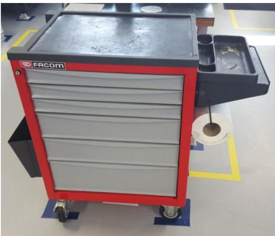
Figura 8 – Carro de ferramentas de auxílio ao torno CNC.
