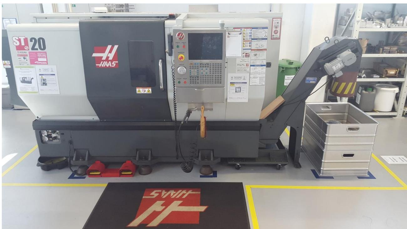
Figura 5 – Torno CNC HAAS ST-20
