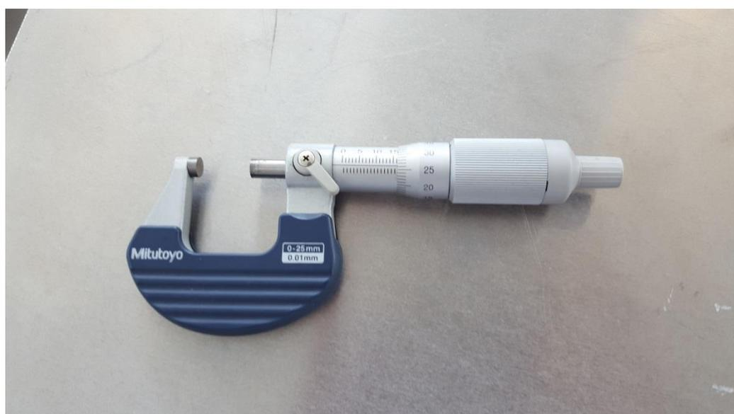
Figura - 13 – Micrómetro (0-25mm)
