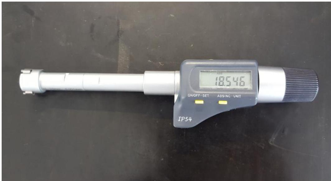
Figura 12 – Micrómetro de interiores (15-20mm)
